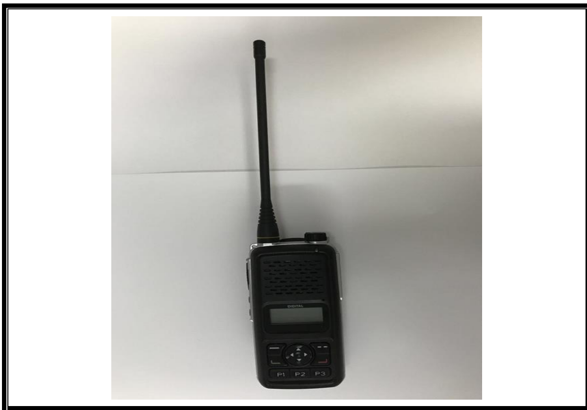
整体照 物理尺寸：长 X 宽 X 高=280mm(L)X 57mm(W)X 42mm(H)
